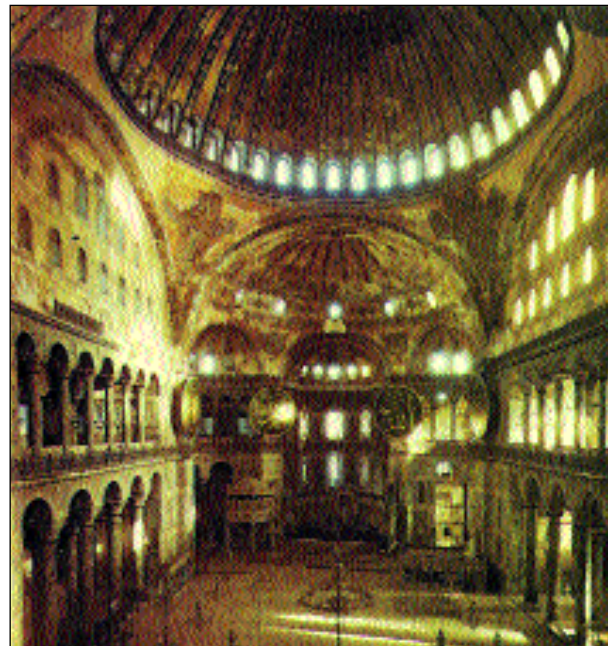
Κάτοψη και τομή του ναού «της του Θεού Σοφίας» στην Κωνσταντινούπολη. Λαμπρό αρχιτεκτονικό έργο της εποχής του Ιουστινιανού. Συνδυάζει την ορθογώνια κάτοψη της βασιλικής με τη θολωτή στέγη των περικέντρων κτηρίων (επάνω). Το εσωτερικό του ναού, όπως είναι σήμερα (δεξιά).
